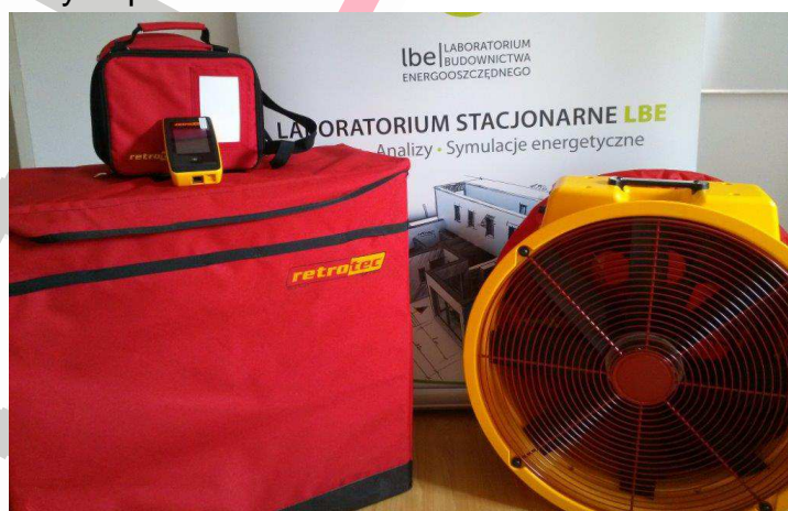
Rys.13. Zestaw do pomiarów szczelności powietrznej budynków Blower Door [5].
